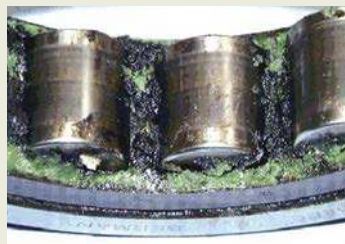
Degradación del lubricante causada por corrientes eléctricas
