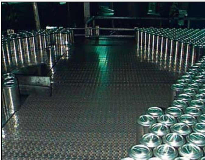
DESCARGA DE LAVADORA DE LATAS CON LA MALLA 5936
