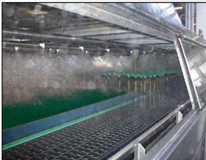
CALENTADOR DE BOTELLAS DE CRISTAL CON MALLA RAISED RIB 2000 Y TRANSFERENCIA DTS-C
