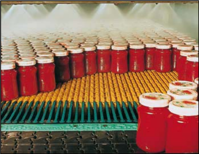
PASTEURIZACIÓN DE TARROS DE CRISTAL EN LA MALLA DE LA SERIE 2500
