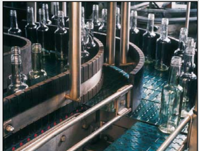
PRODUCCIÓN DE BOTELLAS DE VIDRIO EN MALLA CON FLAT TOP 1005
