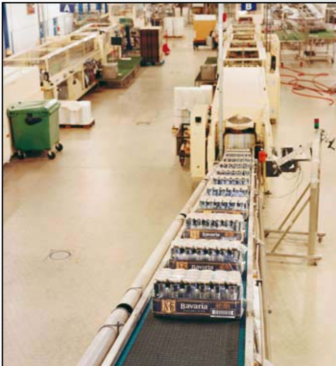
TRANSPORTADOR DE BANDEJAS CON MALLA DE SUPER-GRIP 1005
