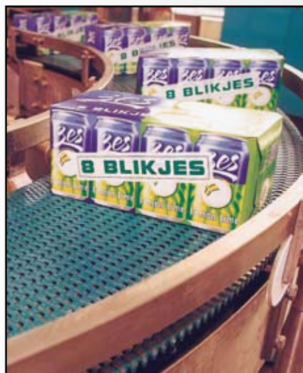
TRANSPORTADOR DE PAQUETES RETRACTILADOS CON LA MALLA DE LA SERIE 505
