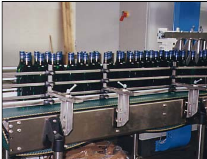
TRANSPORTADOR DE BOTELLAS DE VINO CON MALLA DE LA SERIE 1505
