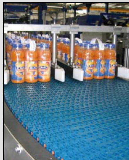
CAJAS TRANSPORTADAS EN CURVA CON LA MALLA DE LA SERIE 7956
