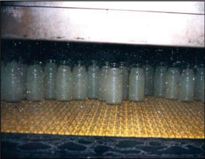
ENTRADA DEL PASTEURIZADOR DE BOTELLAS CON LA MALLA DE LA SERIE 2500
