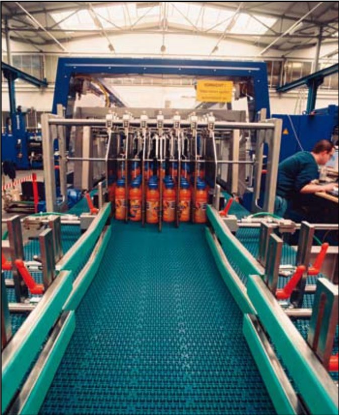
TRANSPORTADOR DE BOTELLAS PEQUEÑAS CON MALLA DE LA SERIE 500
