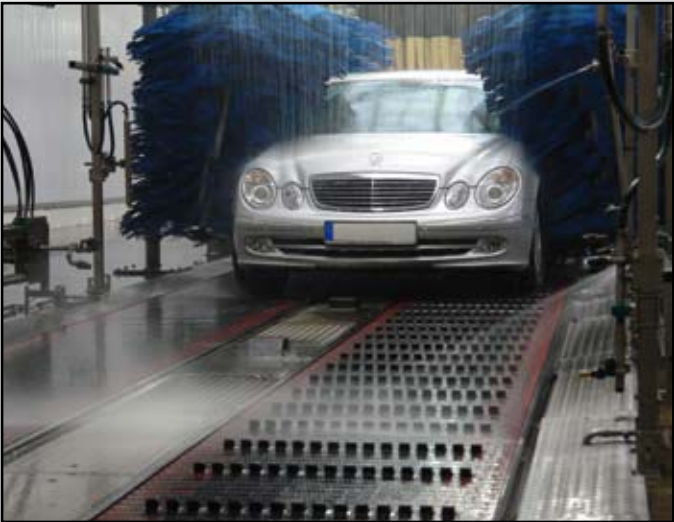
MALLA 6999 SERIE CON EMPUJADORES T2 PARA LAVADO EXTERIOR DE VEHÍCULOS
