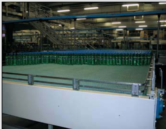
ACUMULACIÓN DE BOTELLAS EN LA MALLA DE LA SERIE 2000
