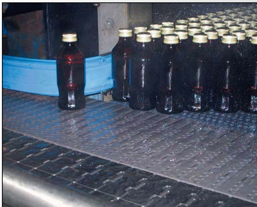
TRANSFERENCIA DE BOTELLAS CON LA MALLA 7705
